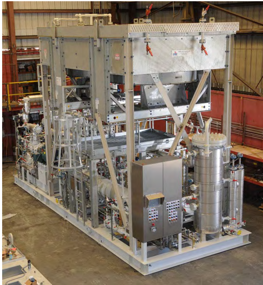
MODULAR LNG PROCESSING PACKAGE
