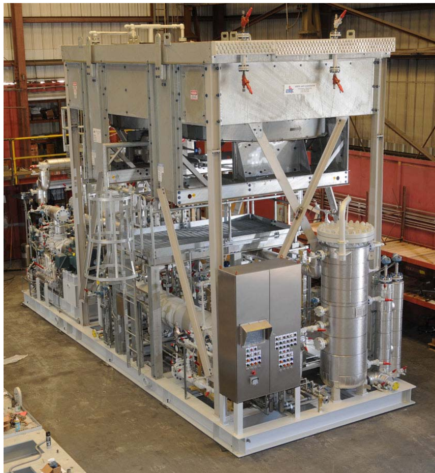
MODULAR LNG PROCESSING PACKAGE
